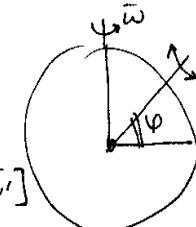
$$\vec{F}_k = -2m[\vec{\omega}\vec{v}] = -2m[\vec{\omega}_0\vec{v}]$$
