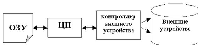
**Синхронное** управление внешними устройствами с использованием контроллеров внешних устройств.
