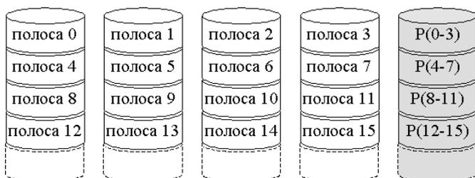
Он не синхронизированный, т.е. в этом плане он аппаратно организован проще, чем предыдущие. Схема примерно та же самая: имеется 4 устройства для логического диска, на которых располагаются полосы, и 5-е устройство, в котором находятся контрольные суммы. Контрольная сумма вычисляется по той же самой формуле, что и в RAID 3. И здесь есть проблема работы в случае независимого обмена.
