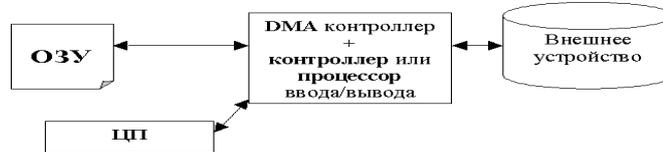
Появление **контроллеров прямого доступа** позволяет вывести поток данных, который появляется при обмене с ВУ из ЦП. Это имеет смысл для блок-ориентированных устройств, подразумевающих большой поток информации. Поток управляющей информации остается в ведении ЦП.
