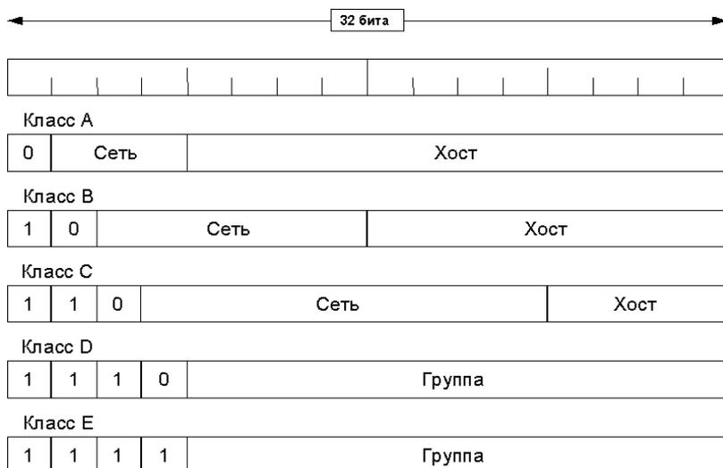
**IP адрес представляется последовательностью четырех байтов. В адресе кодируется уникальный номер сети, а также номер компьютера ( сетевого устройства в сети).**
