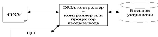
4. Использование **контроллера прямого доступа к памяти (DMA)** при обмене. Управление внешними устройствами с использованием процессора или канала ввода/вывода.
