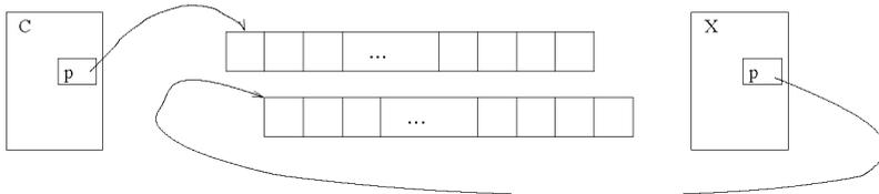
Рис. 2.2. Схема структуры данных после применения конструктора копирования
