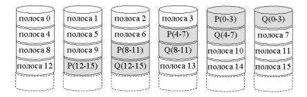
RAID 6 – это двойная избыточность. Делается еще одно дополнительное устройство для хранения избыточной информации.
