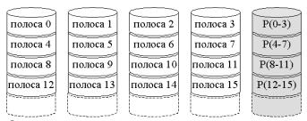
Он не синхронизированный, т.е. в этом плане он аппаратно организован проще, чем предыдущие. Схема примерно та же самая: имеется 4 устройства для логического диска, на которых располагаются полосы, и 5-е устройство, в котором находятся контрольные суммы. Контрольная сумма вычисляется по той же самой формуле, что и в RAID 3. И здесь есть проблема работы в случае независимого обмена.
