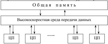
Рис. 2 Архитектура SMP
