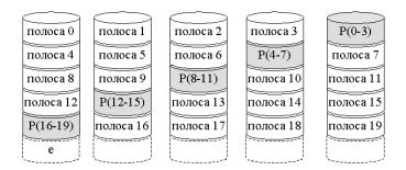
RAID 5 - это использование циклического распределения контрольного диска. Суть: в RAID 3 и RAID 4 есть некоторая диспропорция в распределении потока обмена, т.е. сильно нагружено последнее устройство (это плохо тем, что рано или поздно это устройство выйдет из строя первым), на котором находится контрольная сумма. Т.о. контрольный диск циклически распределен по всем устройствам, т.е. вся работа равномерно распределяется.
