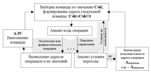
Рабочий цикл процессора определяет основной алгоритм работы процессора и его устройств при выполнении программы. В регистре счетчика команд находится адрес первой команды программы.
