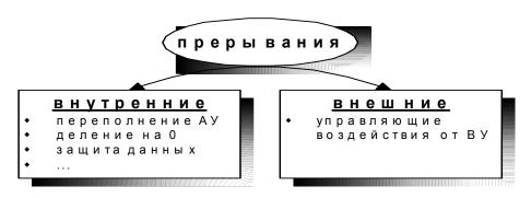
Прерывания можно разделить на две группы внутренние и внешние. Внутренние прерывания инициируются схемами контроля работы процессора. Это может быть реакция ЦП на программную ошибку. Например, деление на ноль. Внешние прерывания — это средство, позволяющее ЭВМ корректно взаимодействовать с внешними устройствами. Это может быть событие, связанное с поступлением новой информации от ВУ или возникновение ошибки во ВУ.
