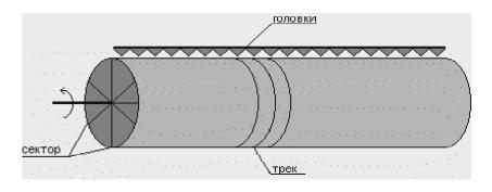
Предназначен больших вычислительных комплексов. Представляет из себя большой цилиндр длиной до метра, в диаметре 30 – 40 см. Поверхность покрыта особым веществом, над поверхностью штанга с головками над треками. Скорость доступа достаточно большая. Механическая составляющая только вращение барабана.
