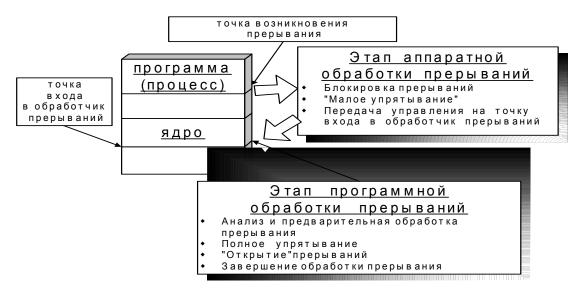
При обработке события, связанного с возникновением прерывания <u>на первом этапе</u> работает аппаратура <u>BC</u>. При этом аппаратно (без участия программы) выполняются следующие действия:
