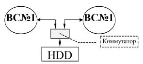
комплекса. Рассмотрим такой пример. У нас есть ММВК, состоящий из двух ВС. Разделяемый ресурс - жесткий диск. Проблема в данном случае явно формулируется так: «Нужно научить две ВС синхронизированно обмениваться с HDD.» Т. е. если программа одной ВС что-то пишет на HDD, то область
