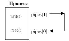
Рис. 7 Обмен через канал в рамках одного процесса.
