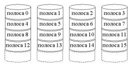
различных блока памяти, к которым поступили два различных запроса ввода\вывода, размещены на различных дисках, вследствие чего эти два запроса могут обрабатываться параллельно.
