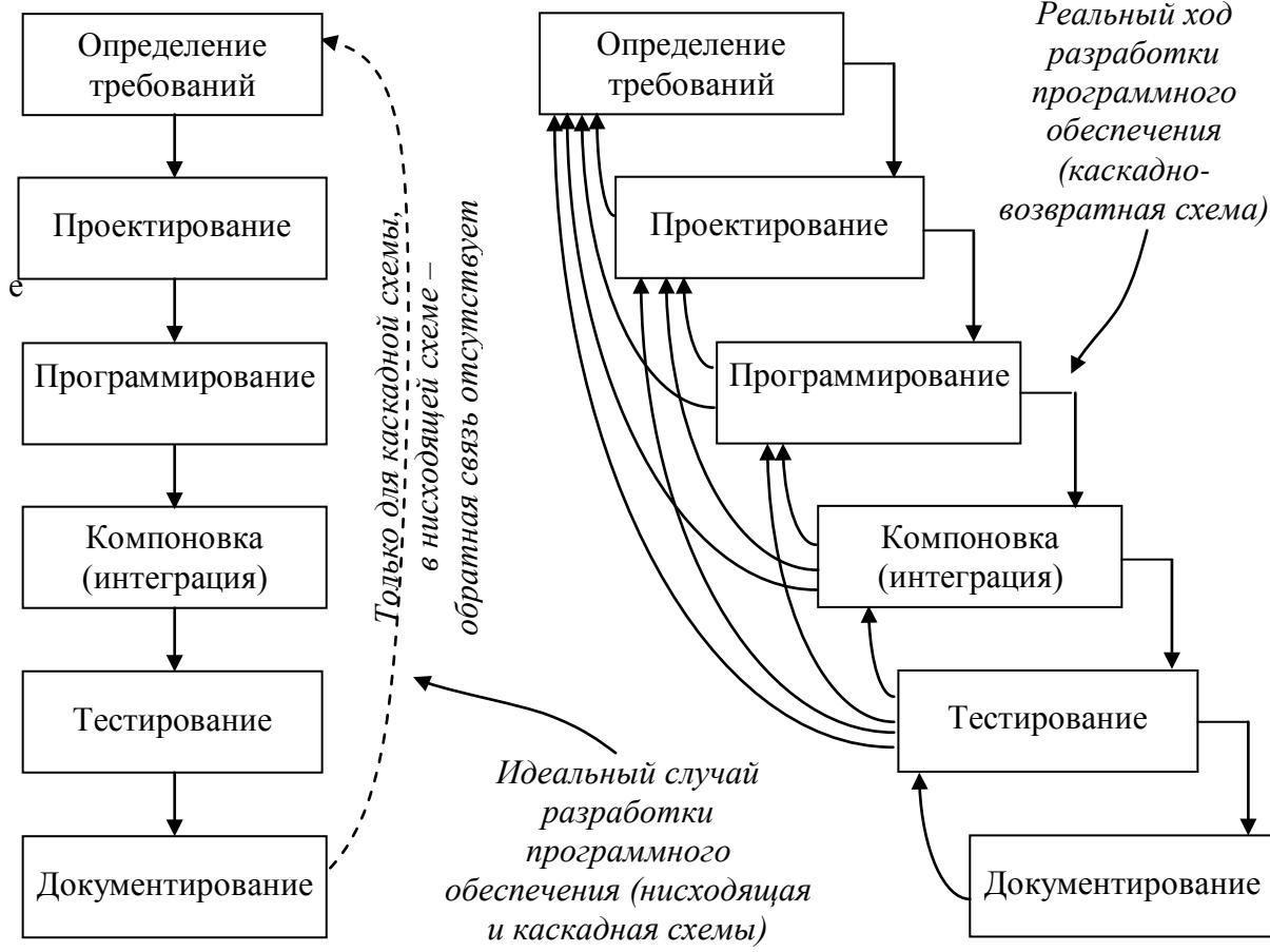
Для преодоления проблем каскадно-возвратного метода используется *спиральная* модель жизненного цикла, упор в которой делается на начальные этапы: определение требований, их анализ и проектирование. На этих этапах реализуемость технических решений проверяется путем создания *прототипов*. Каждый виток спирали
