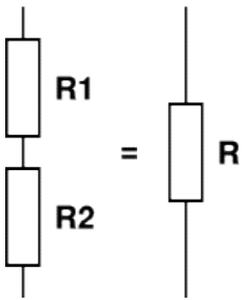
если резисторы R1 и R2 соединены последовательно, их общее сопротивление высчитывается по формуле:
