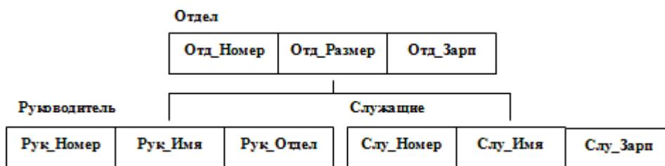
Рис. 2.1. Пример типа дерева
