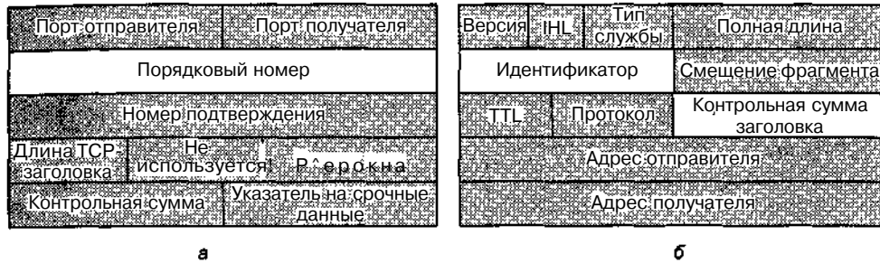
Рис. 6.38. TCP-заголовок (а); IP-заголовок (б). В обоих случаях затененные поля взяты у прототипа без изменений
