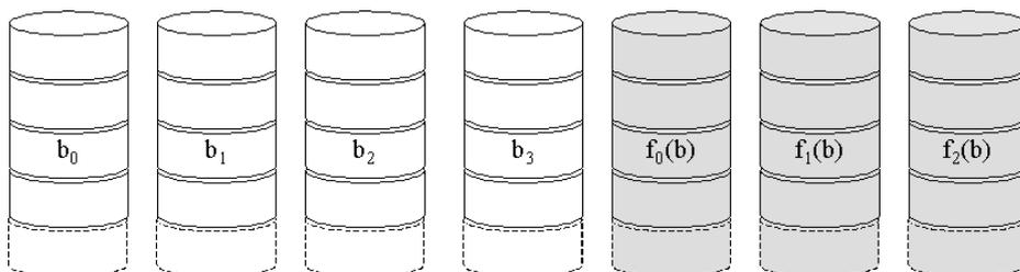
часть дисковых устр-в для хранения содержат информацию логического диска. Схема кодов Хэмминга с исправлением одинарных и определением двойных ошибок.
