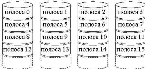
совокупность независимых друг от друга устр-в. нет избыточности информации. Есть возможность предельного доступа в пределах 1 цикла. Полосы, попавшие на разные дисковые устр-ва могут быть параллельными. Ускорение дисковых систем.
