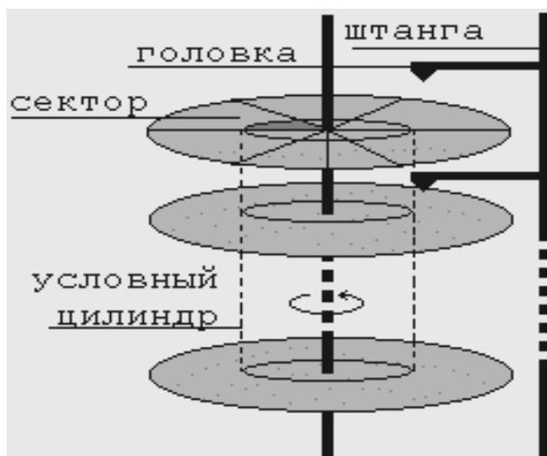
Диск также разбит на равные сектора. Информация на диске адресуется с помощью 4-х координат: № диска, № поверхности, № цилиндра, № сектора.
