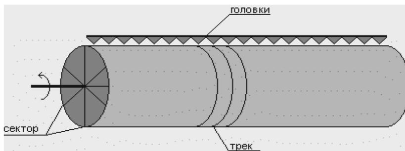
покрыта магнитным слоем, позволяющим хранить, читать и записывать информацию. Поверхность барабана разделена на  $n$  равных частей (в виде колец), которые называются треками (track). Над барабаном расположен блок неподвижных головок так, что над каждым треком
