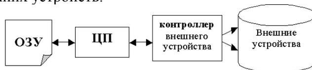
Суть контроллера – упрощение работы ЦП, хотя оно все равно непосредственное; функции обнаружения ошибок; функции, которые обеспечивают ЦП несколько более высокоуровневый интерфейс к внешним процессам (например. Позиционирование головки, выход на нужный сектор).
