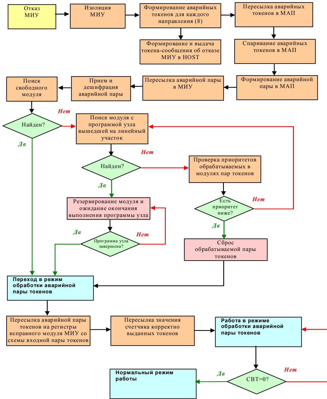
Рисунок 5 – Алгоритм передачи информации, необходимой для восстановления вычислительного процесса, на исправное МИУ в случае возникновения отказа одного из МИУ
