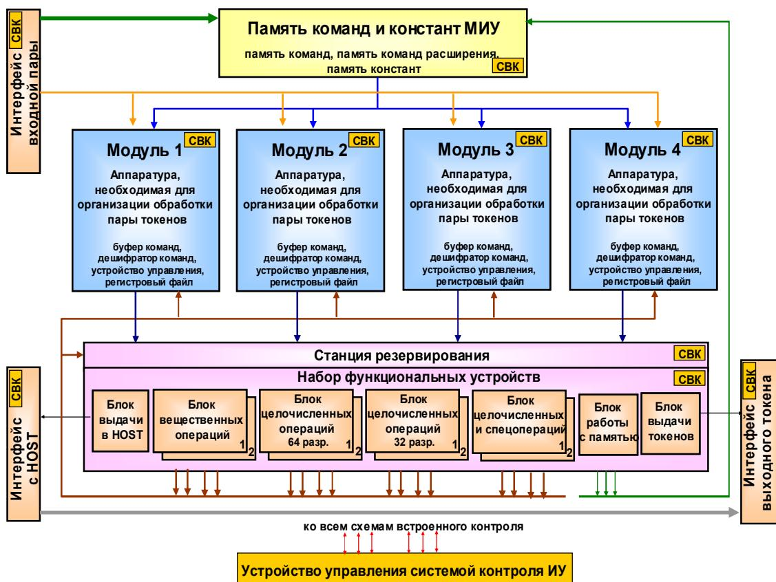
Рисунок 2 – Структура многопоточного исполнительного устройства
