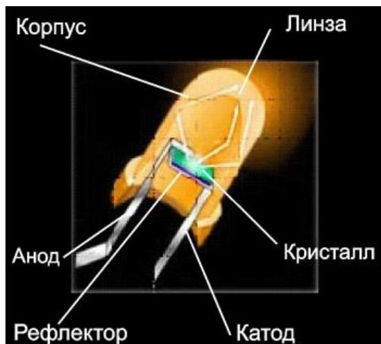
Светодиод (LED) - полупроводниковый прибор с электронно-дырочным переходом (или контактом металл-полупроводник), создающий оптическое излучение при пропускании тока. Спектральные характеристики зависят от структуры и состава использованных полупроводников.
