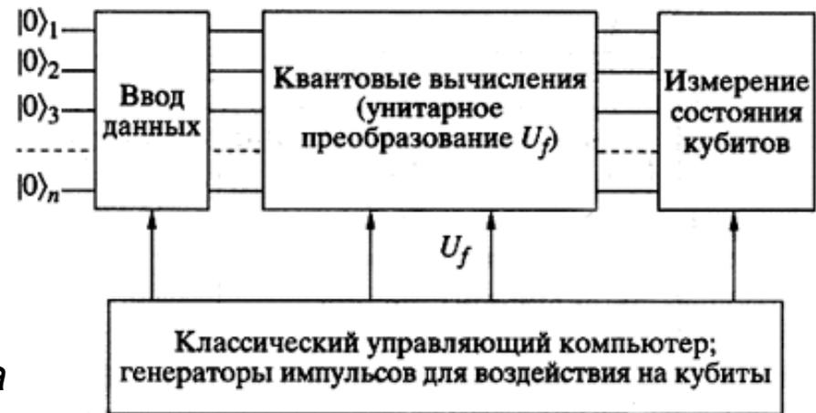
Схема квантового компьютера
