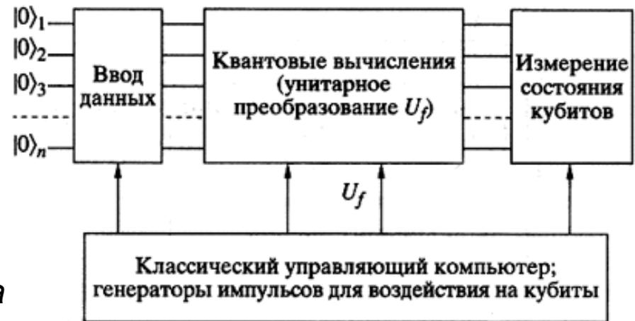
Схема квантового компьютера
