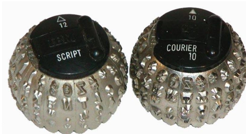
Сферическая печатная головка IBM Selectric
