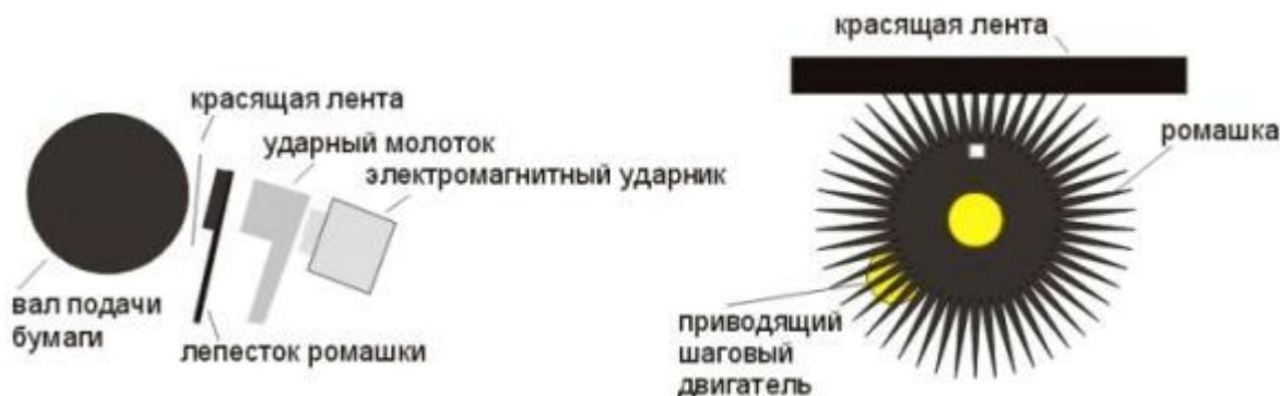
Печатающая головка «ромашка»
