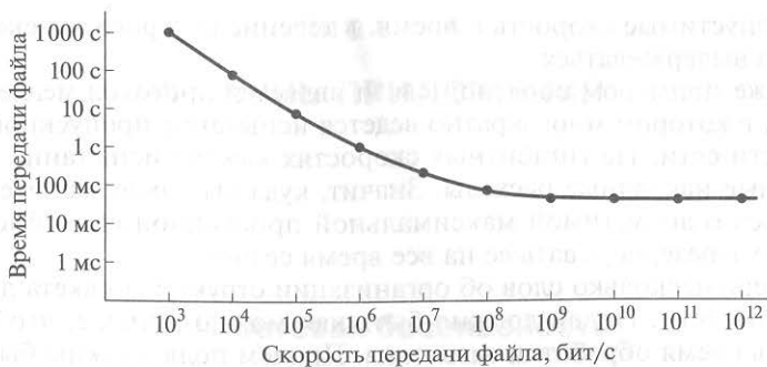
Рис. 3.17. Зависимость времени передачи от скорости передачи для файла размером 1 Мбит на расстояние 4 000 км
