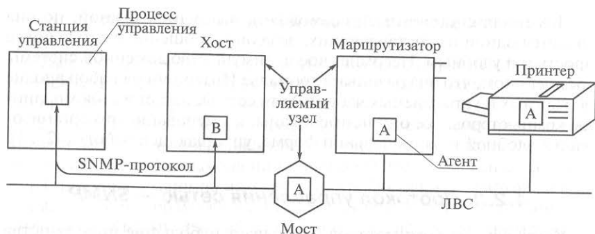
Рис. 4.23. Устройство модели управления SNMP
