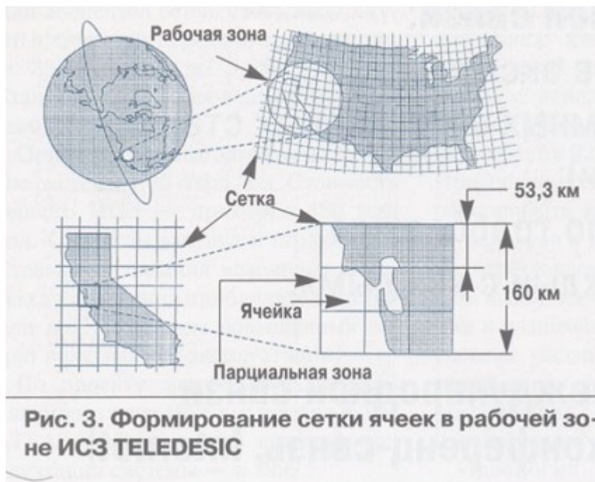
Рисунок 2-84. Формирование сетки ячеек в рабочей зоне ИСЗ TELEDESIC
